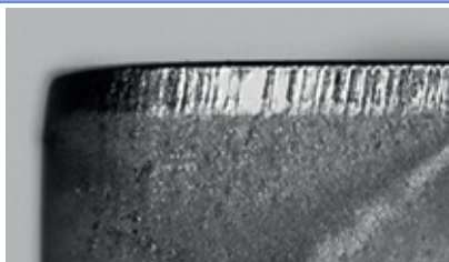
Ścieranie na powierzchni bocznej, normalne zużycie po pewnym czasie obróbki.
