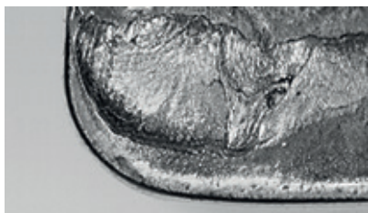
Gorący wiór, który jest odprowadzany, powoduje powstawanie kraterów na powierzchni natarcia krawędzi skrawającej.
